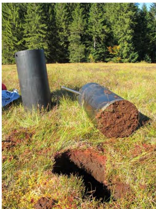
*Figure 37 : Carottier utilisé pour le prélèvement de tourbe. Tourbière de Creusates, Vosges, octobre 2011.*
