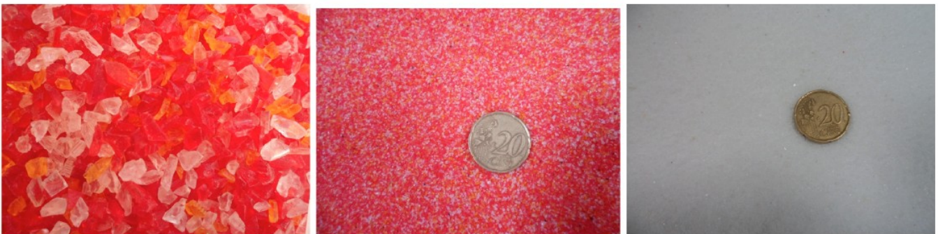
Fig. 6 : Sédiment granulaire synthétique de faible densité utilisé durant l'étude: avant d'être moulu et réduit à la taille utilisée dans les expériences (à gauche), à la taille réelle des expériences PMMA Rouge (au milieu) PMMA Blanc (à droite)
