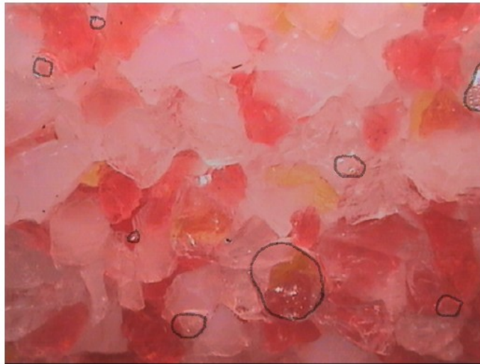
Fig.7: Exemple d'image géoendoscopique et mise en évidence de la présence de bulles d'air
