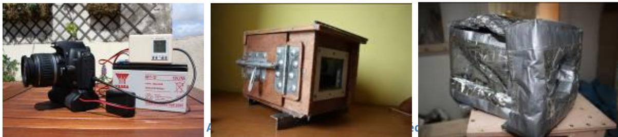
intervalomètre, régulateur, poignée d'alimentation, batterie); caisson recouvert de résine époxy. isolant mince placé à l'intérieur du caisson.
