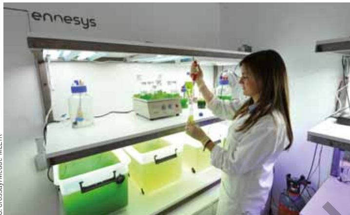
Production d'énergie par culture de micro-algues sur eaux usées. Ennesys, Urbanlab La Défense
