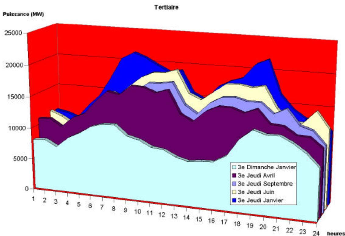
Figure 1.2 - Courbes de charge utilisées par RTE pour modéliser la demande du tertiaire
