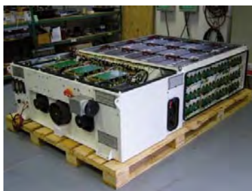
Figure 1: coffre de supercondensateurs et électronique de puissance
