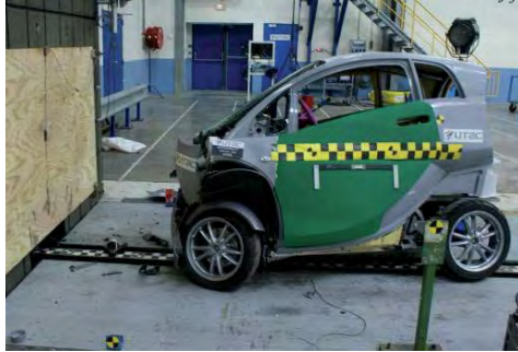
SMERA – Après crash test frontal à 50 Km/h dans un mur (UTAC)
