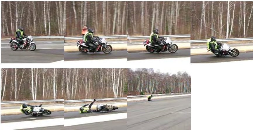
Chute, détection et gonflage du gilet (système sans fil)
