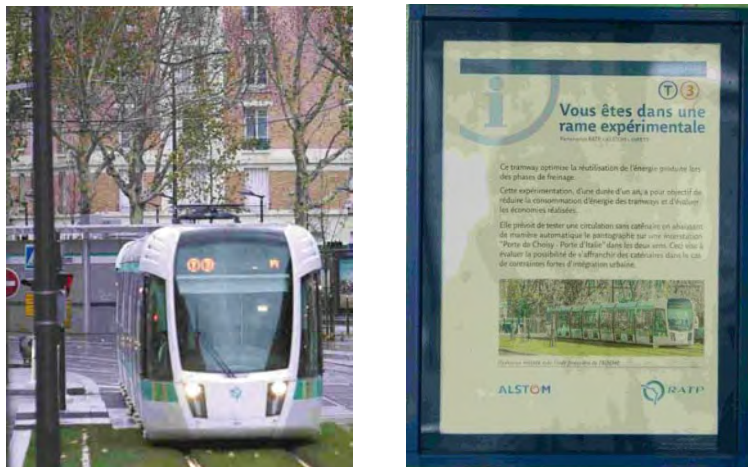
Figure 4 : Rame roulant pantographe baissé
