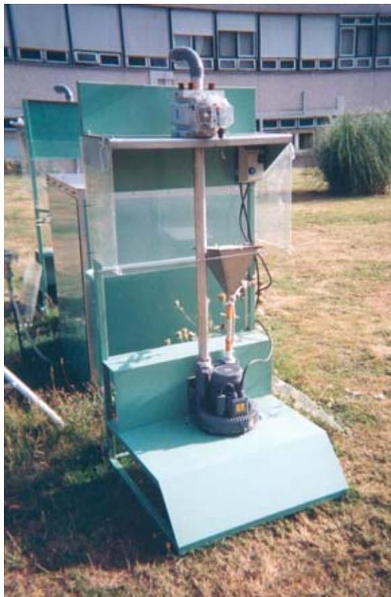
Figure 2 : Le dispositif de prélèvement haut-volume développé dans le cadre de ce projet
