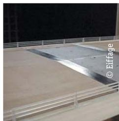
Maquette sectionnelle du tablier du viaduc équipée de prises de pression pariétales pour la mesure de la fonction d'admittance aérodynamique.
