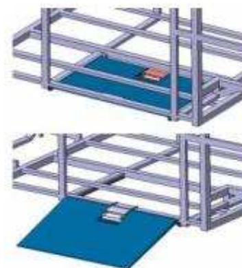
Rampe (accès PMR)
