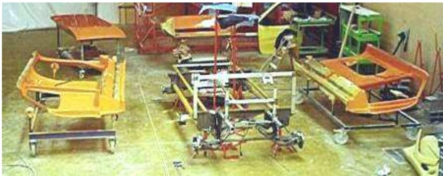
*Exemple de mise en position des éléments de carrosserie avant collage*
