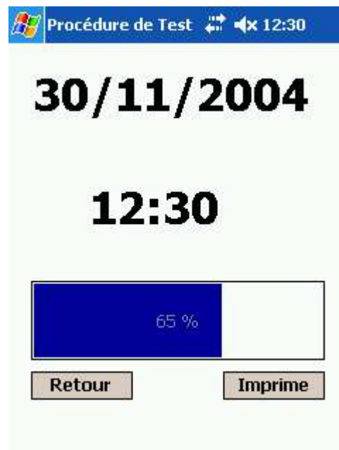
Écran de vérification du bon fonctionnement de l'appareil (date, heure, charge de la batterie, et impression d'un ticket)
