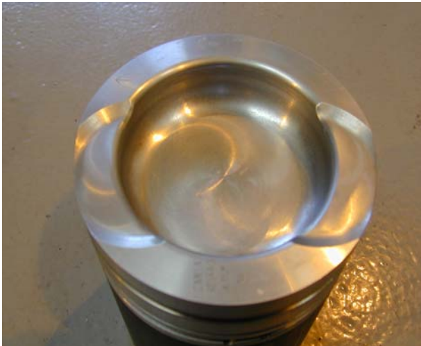
Photo : Vue du piston réalésé en fin d'opération
