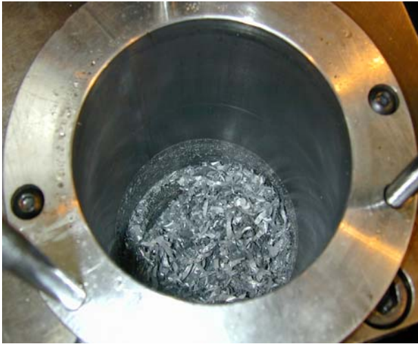
Photo : Vue d'une première coupe de l'opération de réalésage de piston
