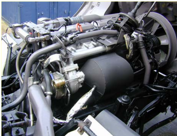
Vue du moteur en fin d'opération de transformation avant la phase d'essais sur route
