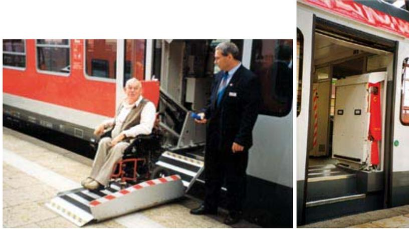
**FIGURE 27 : ÉLEVATEUR INV 300, VERSION FERROVIAIRE (TRAIN ET 425, DB AG)**
