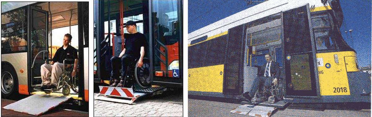
FIGURE 34 : SOLUTIONS DE RAMPES D'ACCES MBB LIFTSYSTEMS AG A BORD DE BUS ET DE TRAMWAYS
