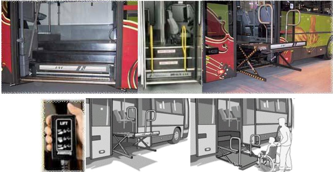
FIGURE 36 : CINEMATIQUE DE LA PLATE-FORME *UVL*
