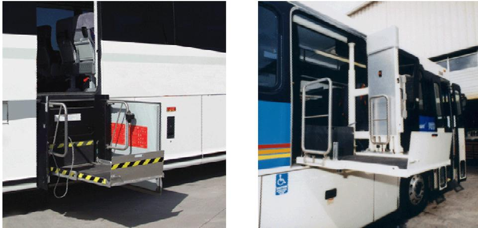
**FIGURE 8 : PLATES-FORMES *BAYLIFT* ET *POWERLIFT***
