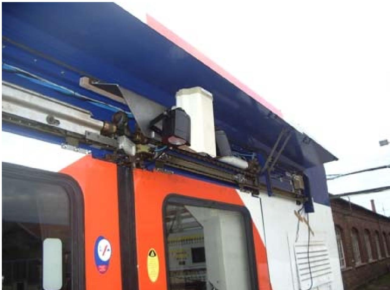
**Figure 2 : Installation de la caméra et des projecteurs au dessus de la porte de la voiture VB2N**
