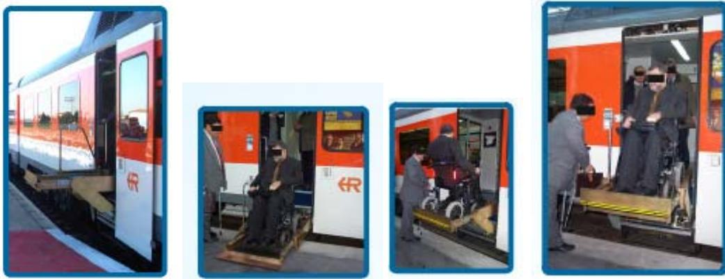
**FIGURE 44 : SOLUTION EMBARQUEE MODILIFT TRAIN 2**
