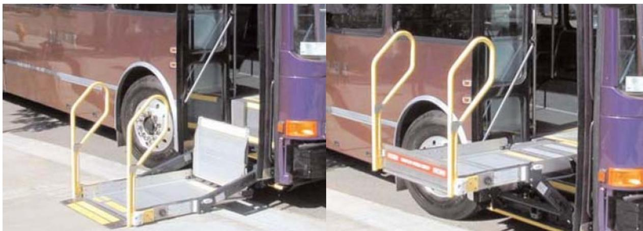
**FIGURE 5 : PLATE-FORME *MIRAGE* EN POSITIONS BASSE ET HAUTE**
