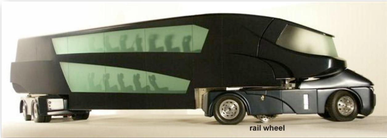
Le concept de Cargorail repose sur une innovation autrement importante. En effet, les « véhicules » MegaRail® sont guidés par des roues munies de pneus roulant à l'intérieur de rails.
