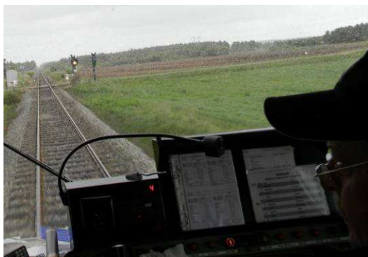
Figure 106 Signal à pied d'oeuvre de PN à fermeture conditionnelle
