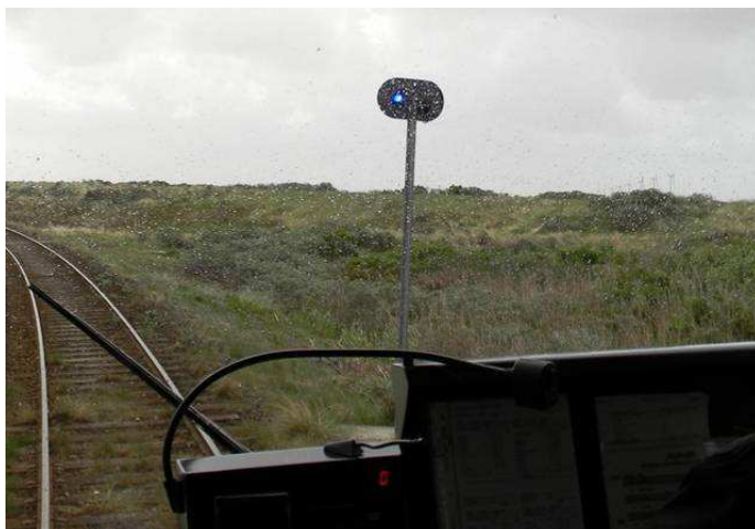
Figure 110 Signal d'arrêt aux haltes à disposition des Voyageurs
