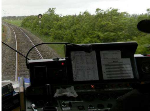
Figure 105 Signal avancé de PN à fermeture conditionnelle
