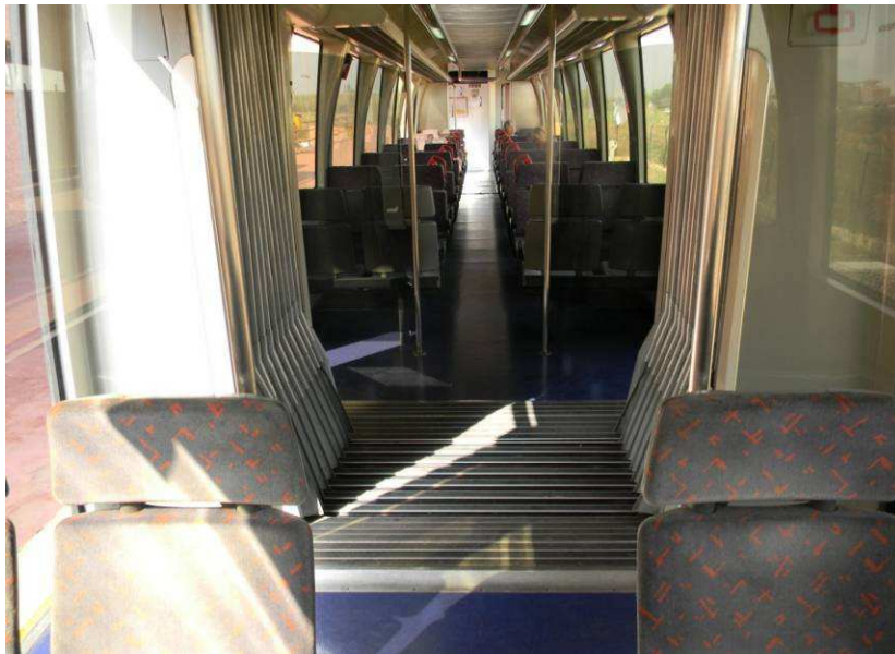
Figure 131 Intercirculation sur une unité type 2600
