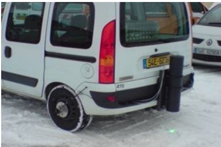
Capteur optique monté sur véhicule (Crédit photo : CETE de l'Est)
