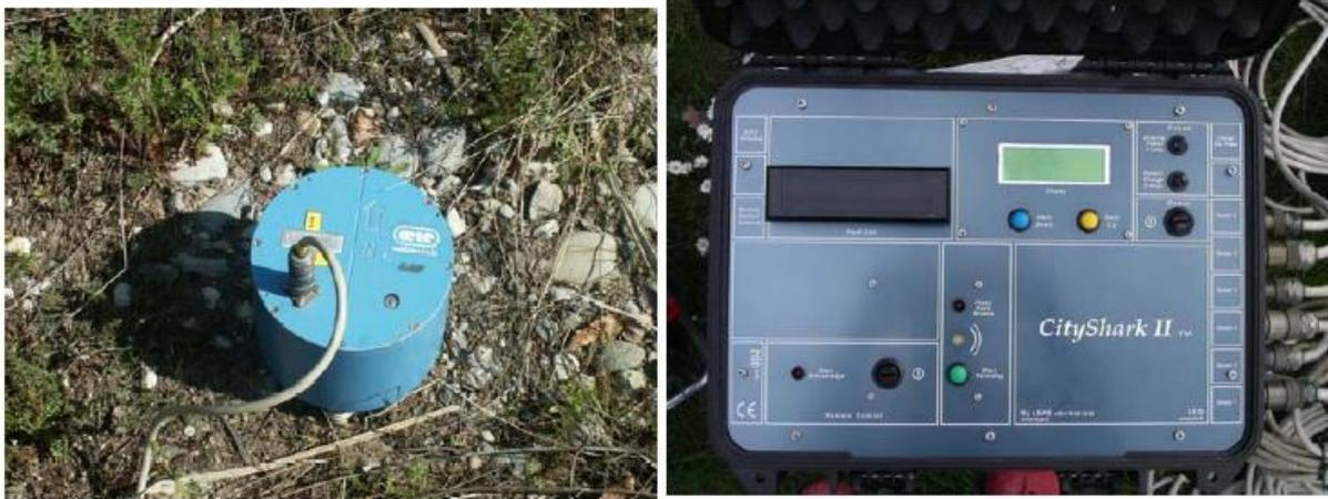
Figure 7 : Capteur et station d'enregistrement utilisés.
