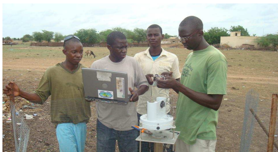
Photo 2 : Initialisation du logger du pluviographe à augets basculeurs à Barkédji
