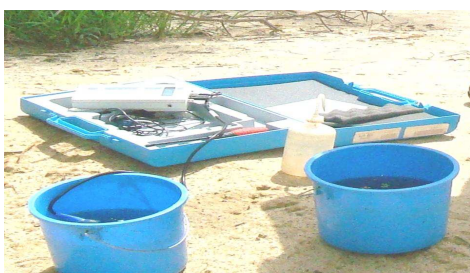
Photo 8 : Capteur Multi-paramètres Consort C561 utilisé pour la collecte des données physico-chimiques au niveau des mares de l'Observatoire Environnement-Santé de Barkédji
