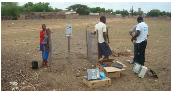
Photo 4 : Finalisation de l'installation du Pluviographe à augets basculeurs à Barkédji
