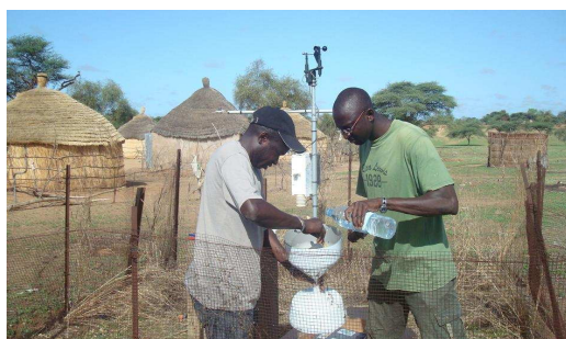
Photo 3 : Maintenance des capteurs à la station météorologique automatique à Niakha
