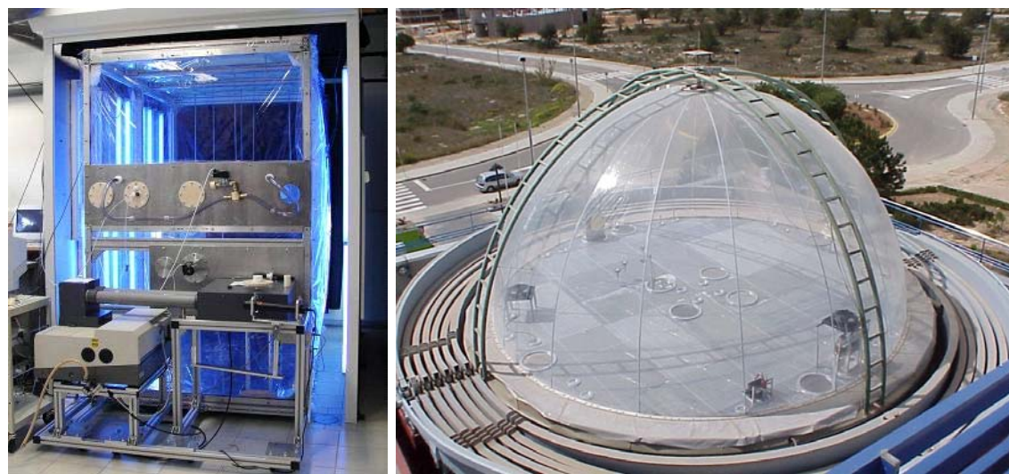
Figure 7 : Photographie des chambres de simulation atmosphérique a) de l'ICARE (Orléans) et b) d'EUPHORE (Valence, Espagne)
