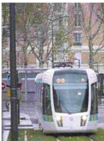
*Pilote de rame de tramway à rechargement rapide en station sur la ligne T3 à Paris, STEEM*
