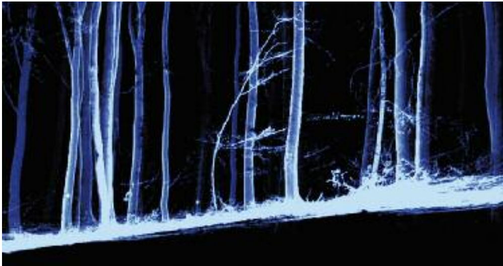
Relevé Lidar terrestre sur une placette d'inventaire forestier
