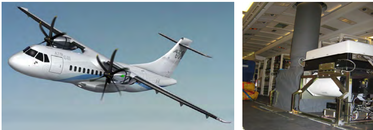
Figure 1.4: Photos de l'avion instrumenté par SAFIRE (ATR-42), vecteur de mesure dans la campagne TRAQA. Photo de la baie instrumentale à bord de l'ATR-42 (Mesures de base, Lidar LNG, PTRMS, etc..) (Photo de G. Ancellet).
