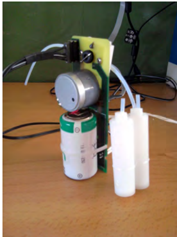
Figure I.8 : Gauche : Sonde pour la mesure de l’ozone ; droite : sonde pour la mesure des aérosols (LOAC pour Light Optical Particle Counter).
