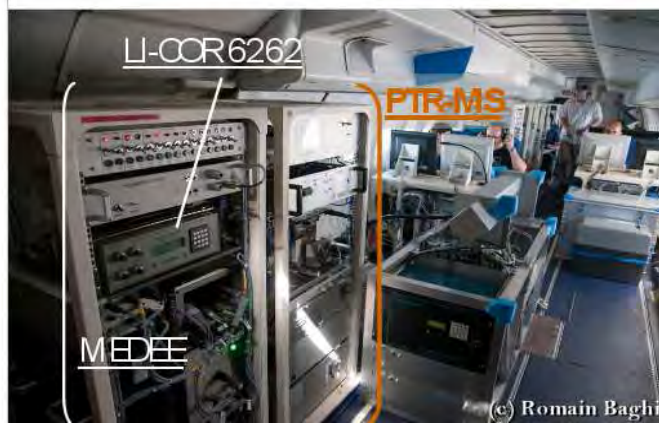
Figure III.2 : Installation de la baie MEDEE dans la cabine de l'ATR-42. La baie de l'analyseur de COV (PTR-MS) est implantée juste à côté.
