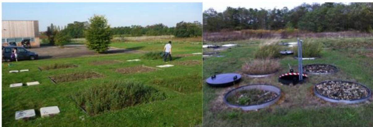
Figure 1 : Le dispositif de parcelles et lysimètres utilisé (station expérimentale du GISFI) sur le site d'une ancienne cokerie à Homécourt (54)
