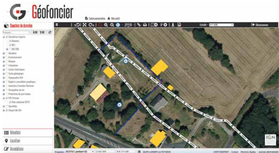
Fig. 1. Cette vue est extraite du portail Géofoncier. On y voit nettement deux sections adjacentes du plan cadastral sur les communes de Saint-Lambert-la-Potherie au nord et Saint-Léger-des bois au sud. Les limites de ces sections pourtant adjacentes figurent en blanc (tirets et croix). Si la section du sud semble géométriquement en place sur le fond d'ortho-image du RGE de l'IGN, la section du nord apparaît très décalée, malgré la réalisation d'un bornage effectué par un géomètre expert (les limites en bleu avec croix rouge proviennent du Référentiel Foncier Unifié – RFU –, référentiel géographique géoréférencé à résolution centimétrique entrepris en France par les géomètres-experts).
