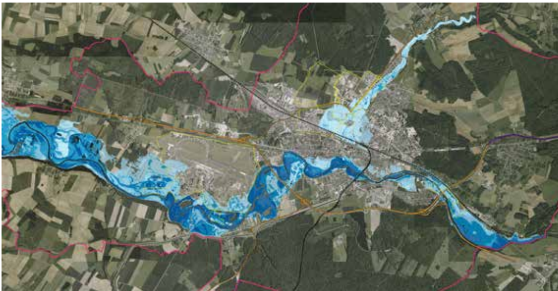
Illustration 3 : Portail Géorisques (MTEs, BRGM) : affichage des couches de données « directive inondation » sur fond d'ortho-image de l'IGN
