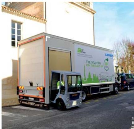
contenant des colis équivalant à 600 kg. Ce véhicule électrique circule à 50 km/h et dispose d'une autonomie de 122 km.
